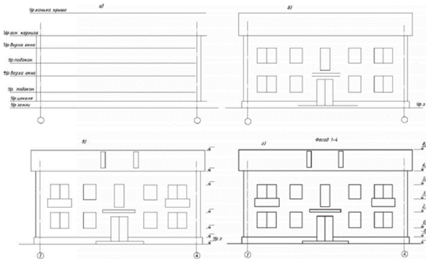
Рис. 6.3.3. Последовательность построения фасада
