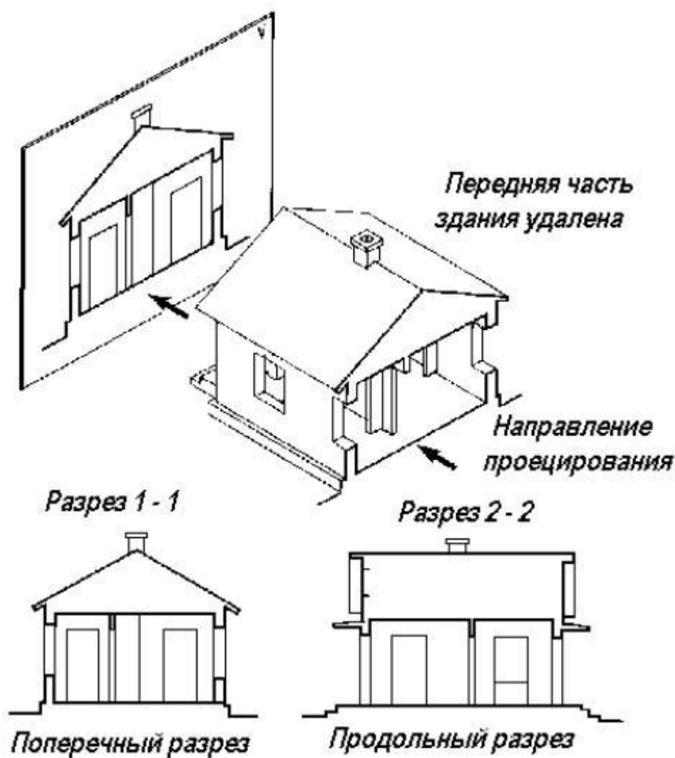
Рис.6.2.1. Образование продольного и поперечного разрезов здания
