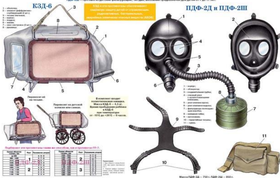
Рисунок 5. Противогазы детские фильтрующие, камера защитная детская.
