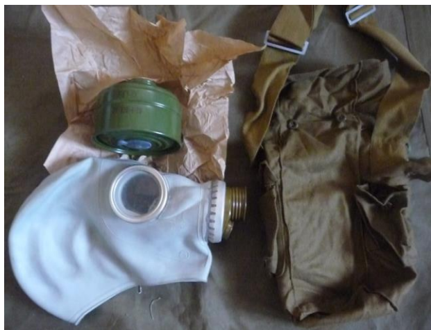
Рисунок 3. Гражданский фильтрующий противогаз ГП – 5.
