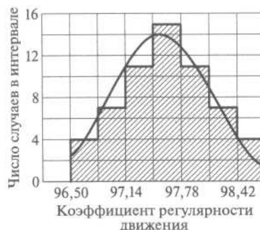
Рис. 2.9 Гистограмма и соответствующая ей теоретическая кривая распределения коэффициента регулярности движения в дифференциальной форме
