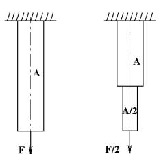
**11.** Максимальные напряжения в изображенных стержнях соотносятся следующим образом...
