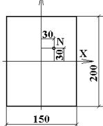
**15.** Какой вид нагружения возникнет в стержне, если в точке N его поперечного сечения, приложить растягивающую силу F?
