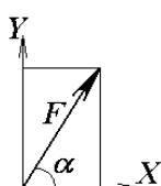
**4)** Определить величину силы по её известным проекциям на две взаимно перпендикулярные оси координат, если  $F_Y = 13 \text{ kH}$ ,  $F_X = 16 \text{ kH}$
