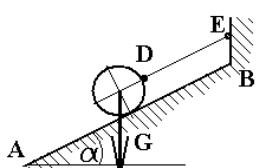
1. На гладкой наклонной поверхности АВ, образующей с горизонтом угол  $\alpha=30^\circ$ , с помощью веревки DE, параллельной плоскости АВ, удерживается однородный шар весом  $G=18$  Н. Определить давление шара на плоскость и натяжение веревки.
