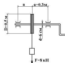
15. Какой вид деформаций возникает в поперечных сечениях указанного стержня?
