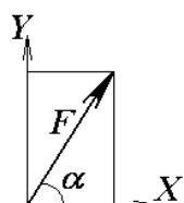
3) Определить величину силы по её известным проекциям на две взаимно перпендикулярные оси координат, если  $F_y = 16$  кН,  $F_x = 14$  кН
