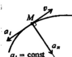
**7)** Точка М движется по криволинейной траектории. Определить характер движения точки по заданным на рисунке характеристикам.
