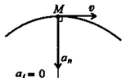
7) Точка М движется по криволинейной траектории. Определить характер движения точки по заданным на рисунке характеристикам.
