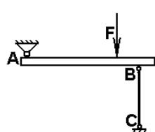
7. По какой формуле проводят проверку прочности стержня BC, имеющего разные допускаемые напряжения на растяжение  $[\sigma_p]$  и сжатие  $[\sigma_{сж}]$ ?
