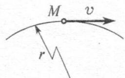
**12)** Точка  $M$  движется криволинейно и неравномерно. Выбрать формулу для расчёта модуля нормальной составляющей силы инерции
