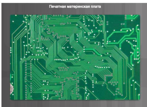
Материнская плата, которая также называется системной или основной платой, является основой компьютера. Как показано на рис. 1, материнская плата представляет собой печатную плату, на которой размещены шины (или электрические дорожки) для соединения электронных компонентов друг с другом. Такие компоненты могут быть как встроенными в материнскую плату, так и устанавливаться дополнительно в соответствующие разъемы, слоты расширения и порты.
