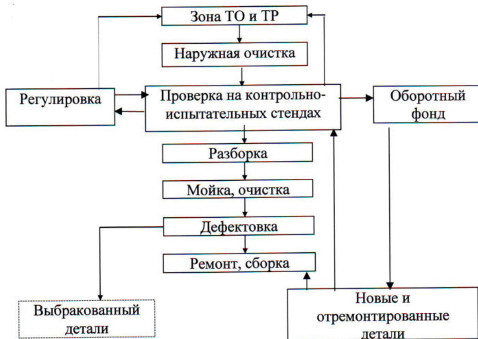
Схема технологического процесса цеха ремонта топливной аппаратуры
