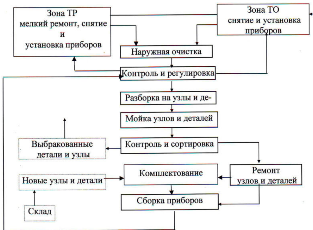
Схема технологического процесса цеха ремонта топливной аппаратуры
