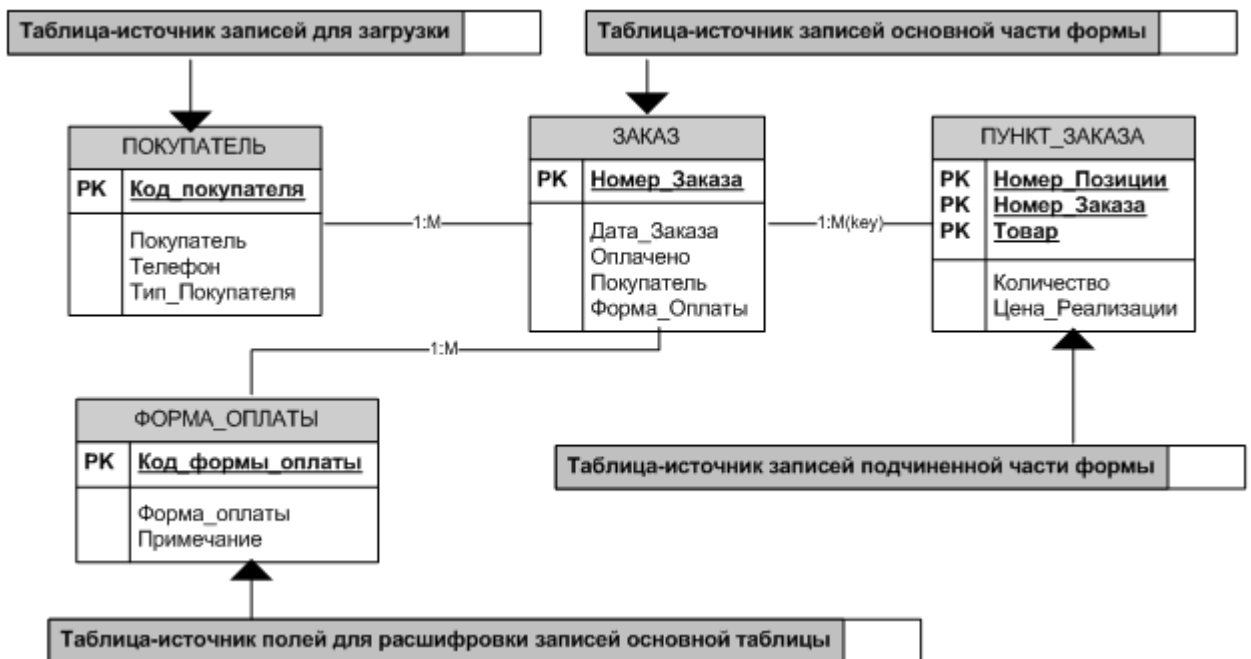
Рис.7. Подсхема данных для конструирования формы на базе таблицы ЗАКАЗ Источник записей для основной части формы ЗАКАЗ – поля таблицы ЗАКАЗ. Поля таблицы ПУНКТ_ЗАКАЗА являются источниками записей подчиненной формы. Для поля основной части ПОКУПАТЕЛЬ источником записей будет таблица ПОКУПАТЕЛЬ. Для поля ФОРМА_ОПЛАТЫ источником записей – поля таблицы ФОРМА_ОПЛАТЫ. Реализацию списков записей для полей ПОКУПАТЕЛЬ и ФОРМА_ОПЛАТЫ в основной части формы удобно выполнить с помощью элементов управления ПОЛЕ СО СПИСКОМ. Реализацию полей подчиненной формы удобно выполнить с помощью вложенной формы. Следовательно, необходимо предварительно разработать подчиненную форму ПУНКТ_ЗАКАЗА.
