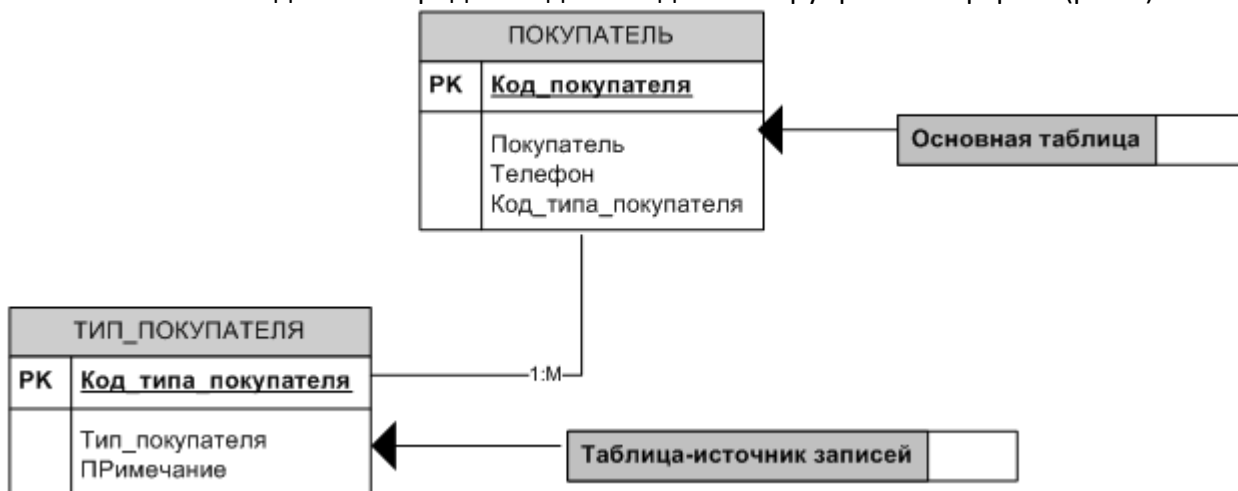
Рис.1. Подсхема данных для конструирования формы на базе таблицы ПОКУПАТЕЛЬ Источник записей для поля КОД_ТИПА_ПОКУПАТЕЛЯ – таблица ТИП_ПОКУПАТЕЛЯ. Реализацию источника записей удобно выполнить с помощью элементов управления СПИСОК или ПОЛЕ СО СПИСОКОМ.
