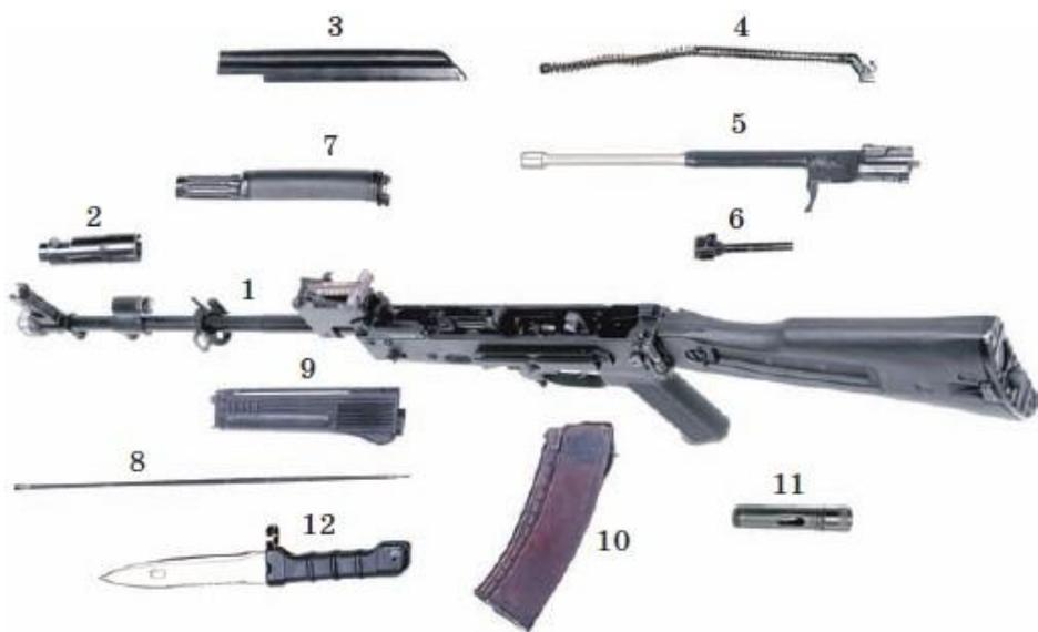
*Рис. 35. Основные части и механизмы автомата АК-74: 1 — ствол со ствольной коробкой, прицельным приспособлением и прикладом; 2 — дульный тормоз-компенсатор; 3 — крышка ствольной коробки; 4 — возвратный механизм; 5 — затворная рама с газовым поршнем; 6 — затвор; 7 — газовая трубка со ствольной накладкой; 8 — шомпол; 9 — цевьё; 10 — магазин; 11 — пенал принадлежности; 12 — штык-нож*
