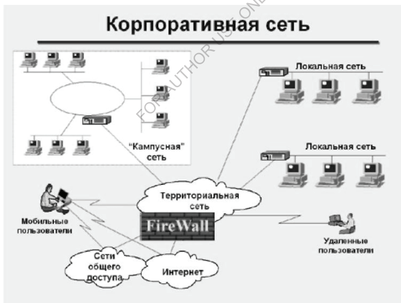
Рис. 20. Объединение различных сетевых каналов коммуникации в корпоративную сеть
