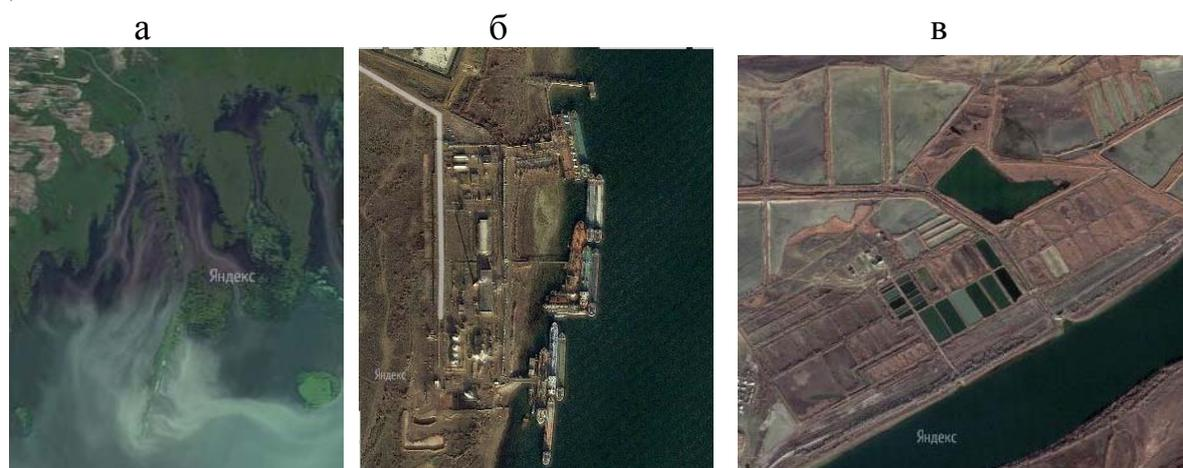
Рис. 3. Космические изображения Волго-Каспийского канала и некоторых источников загрязнения: а – сток транзитной речной воды через прораны насыпных островов; б - погрузочно-разгрузочный порт (нефтяные углеводороды, тяжелые металлы, балластные воды); в – рисовые чеки и дренажные каналы для сброса избыточного объема воды, содержащей гербициды, пестициды и взвесь плодородного грунта
