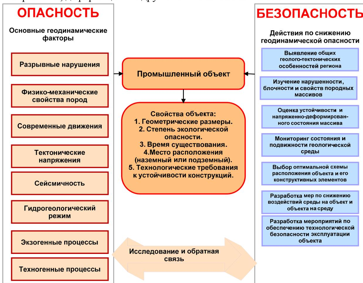
Рис. 3. Логическая схема обеспечения геодинамической безопасности объектов ЯТЦ
