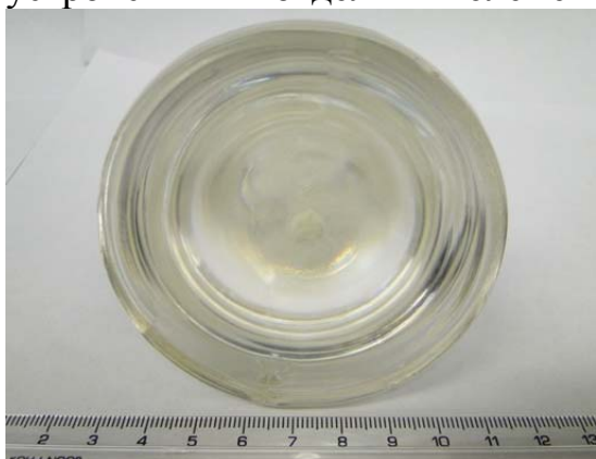
Рис. 3 – Крупногабаритный монокристалл парателлурита диаметром 85 мм и высотой 79 мм, выращенный способом Чохральского на кафедре прикладной физики ТвГУ
