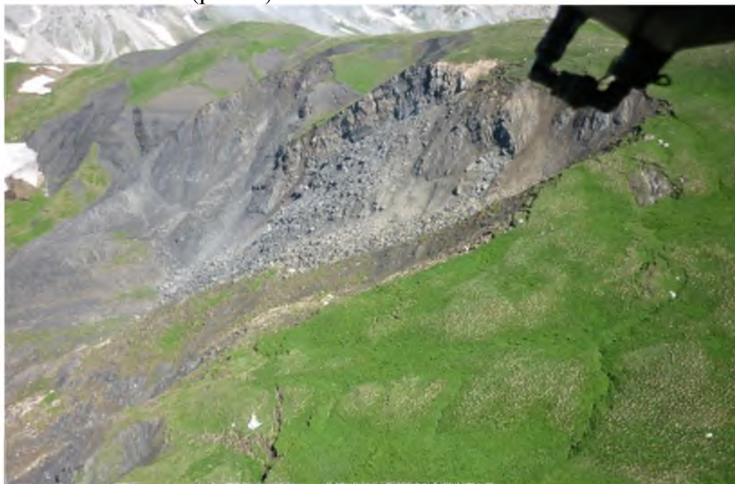
Рис. 2. Стенка срыва обвала с намеченными трещинами откола в коренном склоне (09.06.2012г. ЮРЦГМСН)
