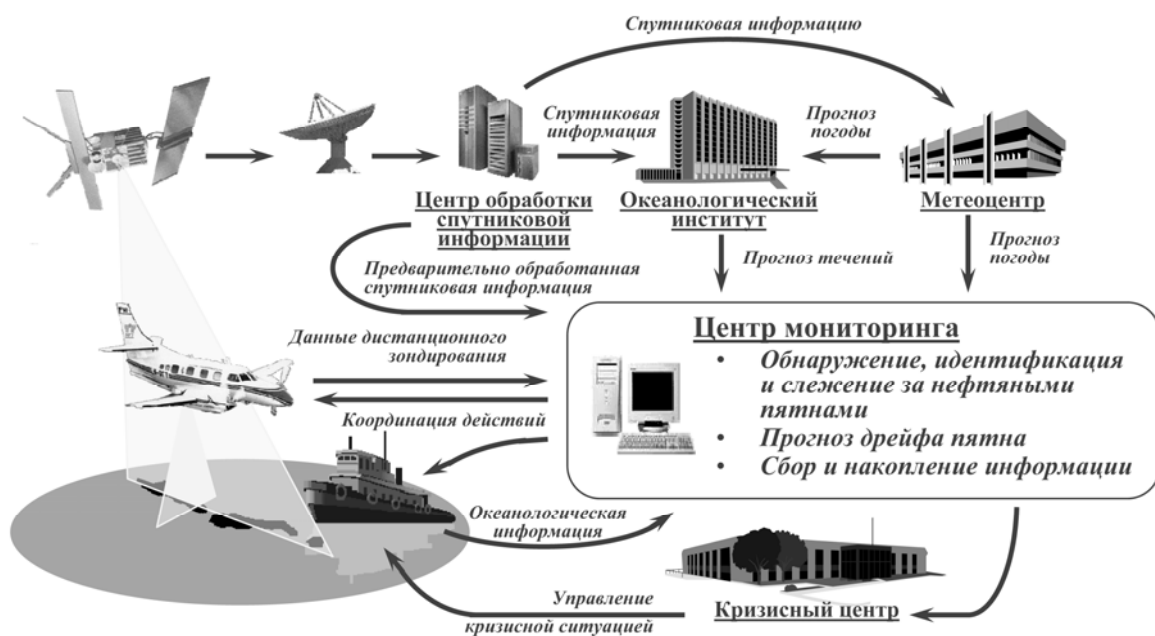
Рис. 3. Схема оперативного спутникового мониторинга.
