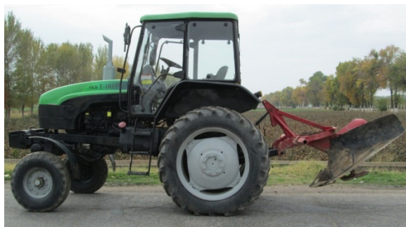
Рис. 1. Трактор ТТЗ-1033 в агрегате с каналокопателем-бороздоделателем КБН-0,35А, вид сбоку
