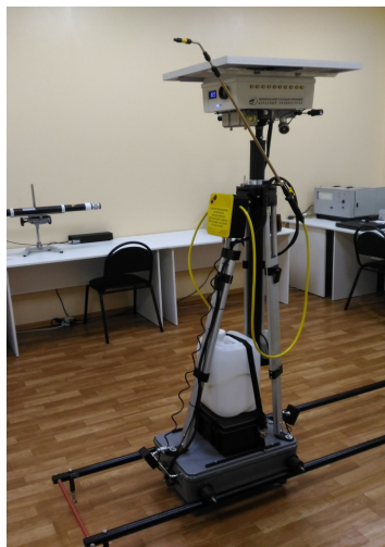
Рисунок 1. Роботизированная платформа для экологически безопасной защиты тепличных растений от болезней на испытательном стенде в лаборатории
